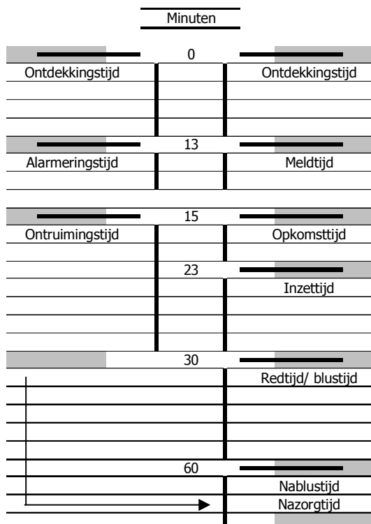
Figuur 1 Fasen in het normatief brandverloop, afkomstig uit de Brandbeveiligingsconcepten.
